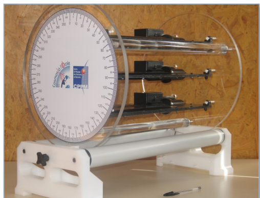
Le cosmodétecteur mis à disposition des établissements scolaires du réseau « COSMOS à l'École ». Crédits photo : Sciences à l'École.
